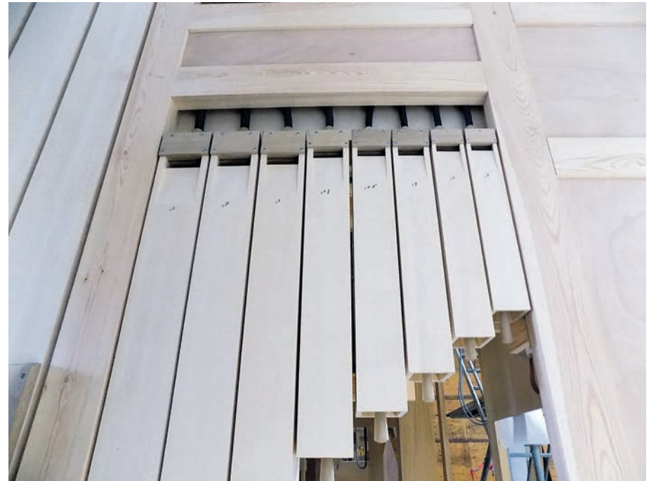
A pesar de que la mayoría de tubos son una aleación de estaño y plomo, también los hay de madera.
