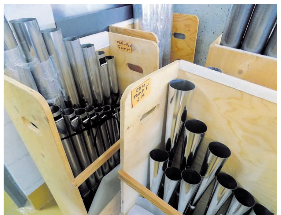
Los tubos son el material sonoro, la base del instrumento y, en el caso de los del órgano de la Merced, están marcados con las letras BBM (Barcelona Basílica Merced).
