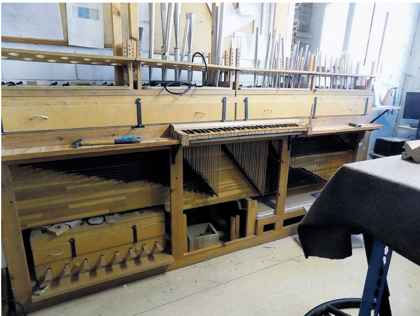
El maniquí es un órgano donde se prueban y ajustan los tubos por parte del armonizador.
