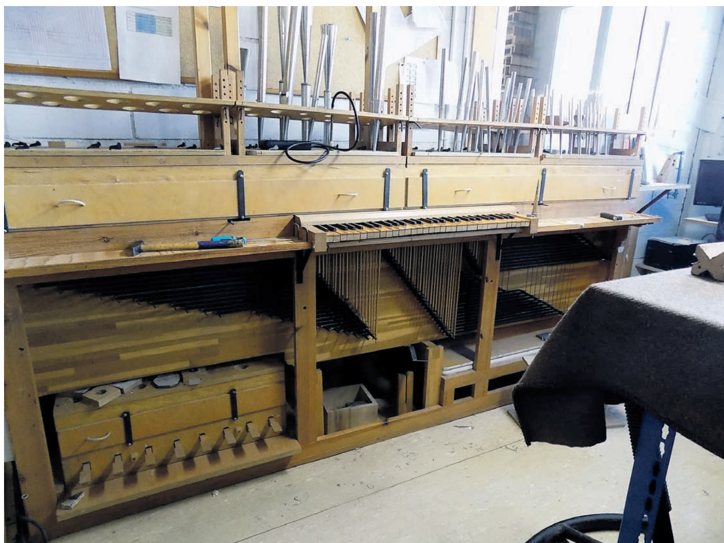
El maniquí és un orgue on es proven i ajusten els tubs per part de l'harmonitzador.
